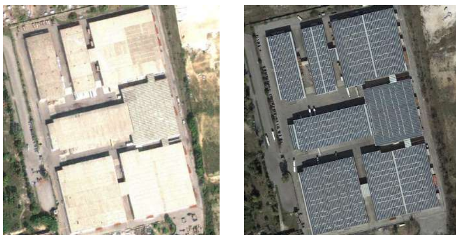
Figura. Esempi di tetti fotovoltaici (circa 5 ettari), comune di Tivoli (Roma). Impianto da oltre 4,2 MW. A sinistra prima dell'intervento, a destra dopo l'intervento
