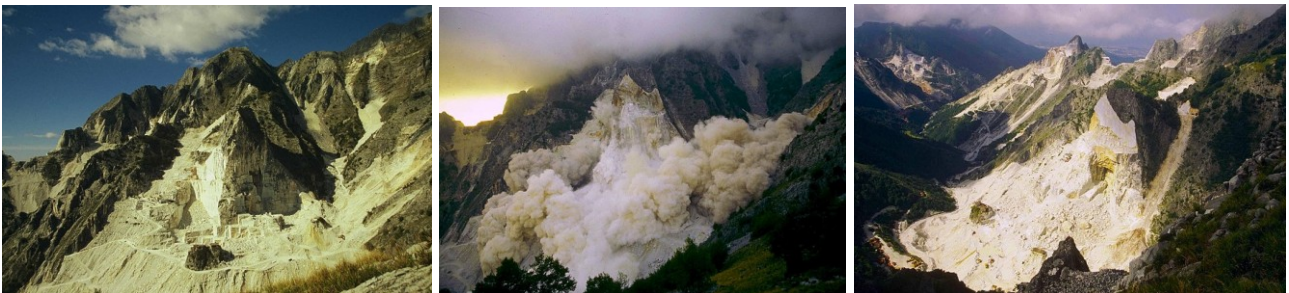
Canale di Colonnata prima, durante e dopo la varata (termine tecnico per indicare l'esplosione)
