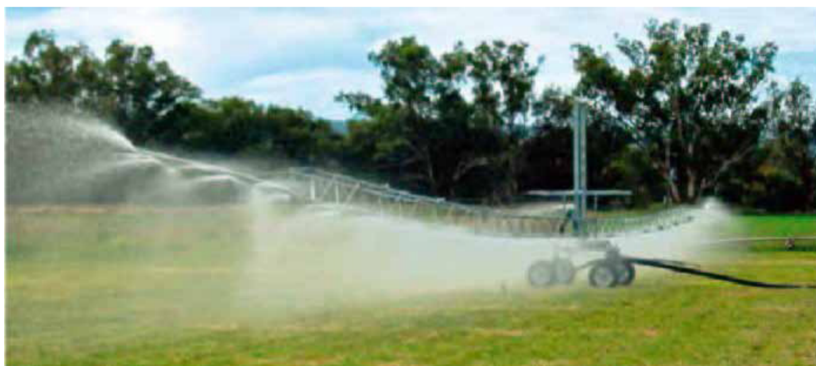
Fig. 56 - Irrigazione a pioggia con irrigatore semovente ad ala piovana, Foto da: www.cic.cr.it (per gentile concessione di Stefano Giovanni Loffi)
