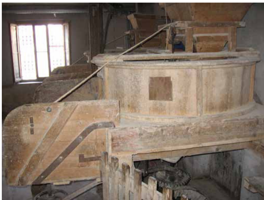
Fig. 71 - Interno del mulino di San Rocco. Si notino le mole e sotto di esse gli ingranaggi Foto di Valerio Ferrari
