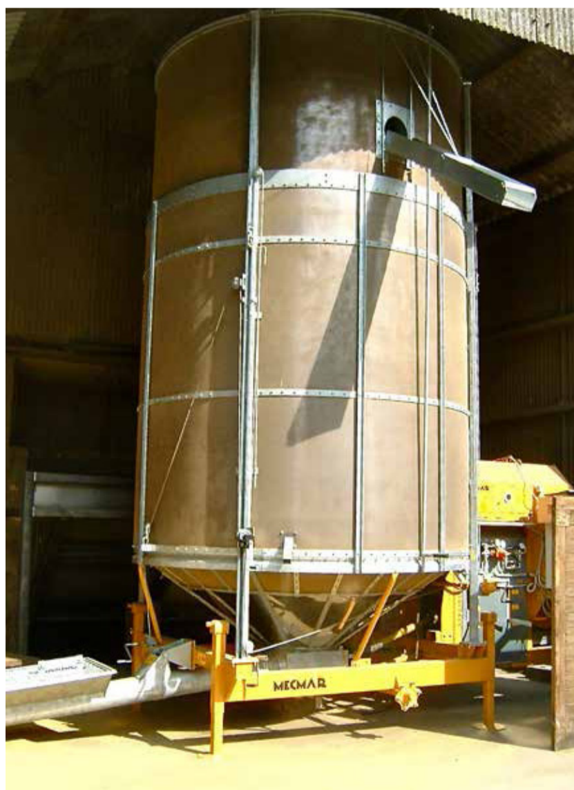
Fig. 37 - Essiccatoio per cereali, Foto da: http://blog.mecmargroup.com/wp-content/uploads/2012/04/Essiccatoio-usato-Mecmar.jpg
